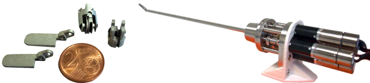
Abbildung 3: Links: Mittels SL \mu M gefertigte Einzelteile einer Zangenspitze für die Laparoskopie; rechts: mechatronische Antriebseinheit für laparoskopische Instrumente
